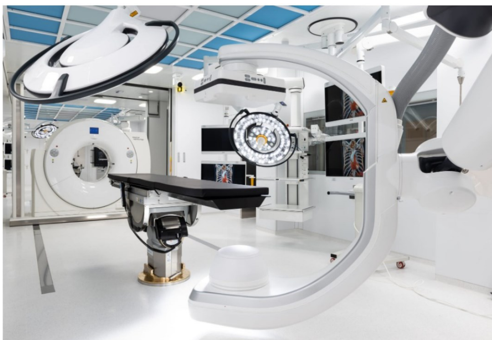
Figura 3.17: una delle due sale ibride gemellari. In primo piano l'arco a C dell'angiografo, in secondo piano la TAC a scorrimento [29].
