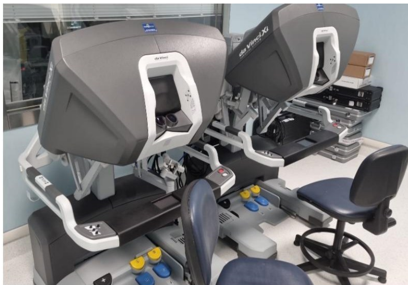
Figura 3.7: la doppia consolle di comando per il “Da Vinci Xi” [23].
