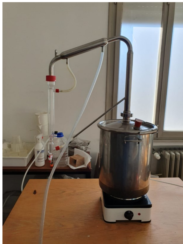
Figura 3.2 Schema di funzionamento del distillatore in corrente di vapore (a) (Denny,2002) e distillatore utilizzato durante la prova (b).
