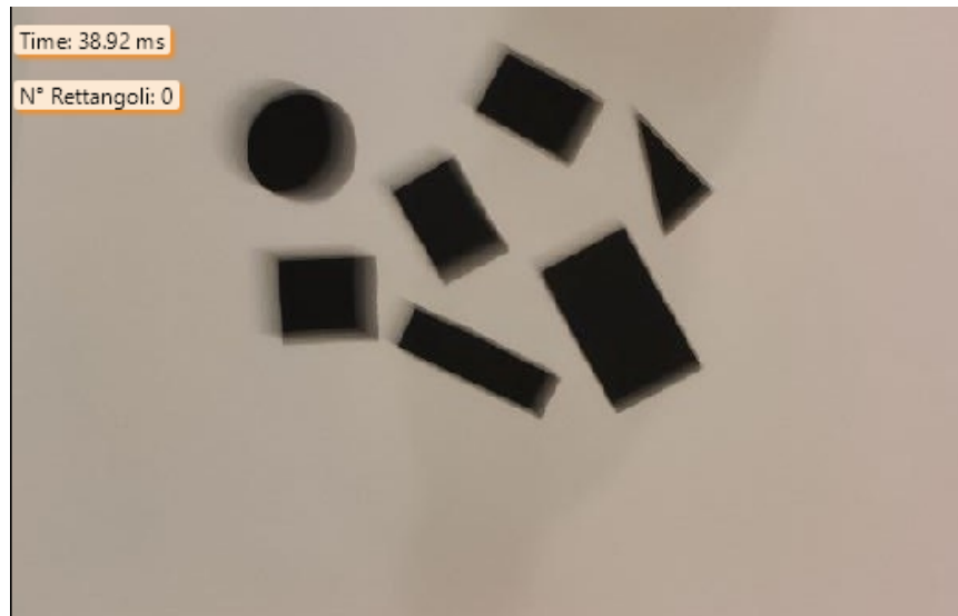
Figura 2.9: Esempio di applicazione della Blob Analysis nel caso di motion blur.
