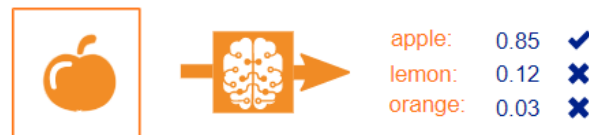
Figura 3.10: Un possibile esempio di classificazione, in cui la rete neurale distingue tre classi. L'immagine di input riceve valori di confidenza assegnati per ciascuna delle tre classi distinte: 'mela' 0,85, 'limone' 0,12 e 'arancia' 0,03. La previsione principale ci dice che l'immagine è stata riconosciuta come "mela" [5].
