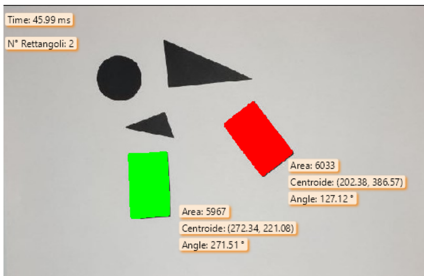
Figura 2.5: Esempio 1 di applicazione della Blob Analysis in Halcon per il riconoscimento di rettangoli.
