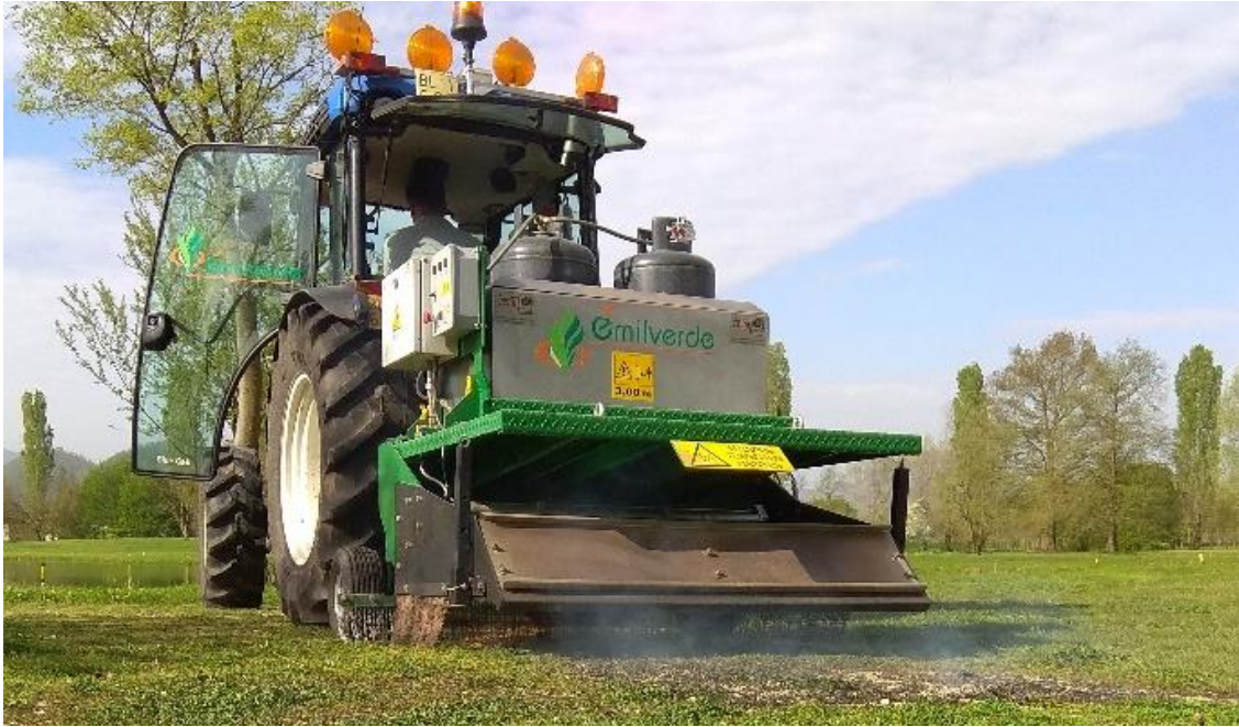
Figura 3.9. Macchina per il pirodiserbo in azione al campo da golf della Montecchia
