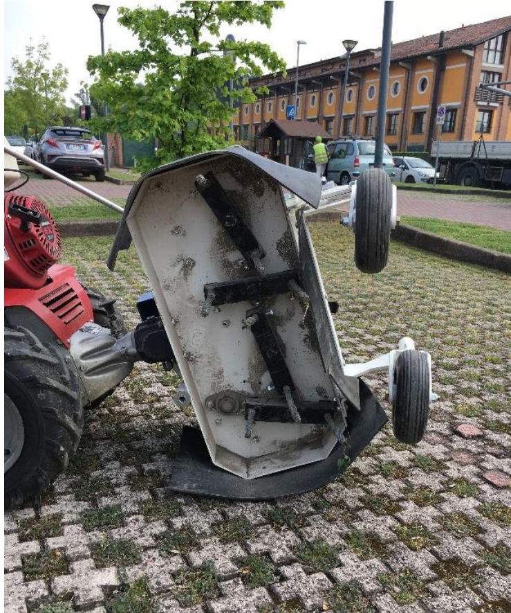
Figura 3.8. Organo di lavoro della macchina scerbatrice
