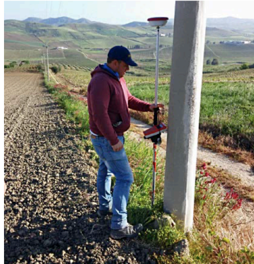
Foto 7: Mappatura di confini e ostacoli tramite palina
