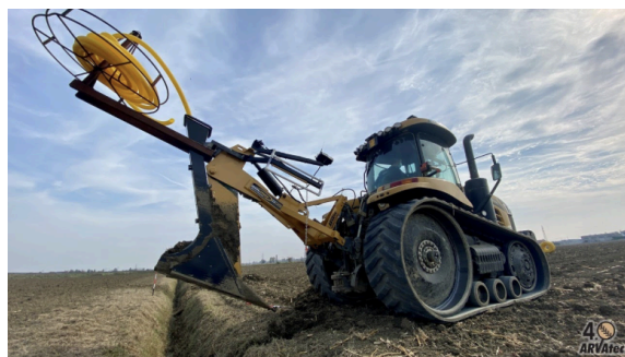
Foto 2-3: Nella prima immagine viene mostrato il macchinario che esegue la messa a dimora dei tubi di drenaggio, nella seconda si può notare il risultato ottenuto.
