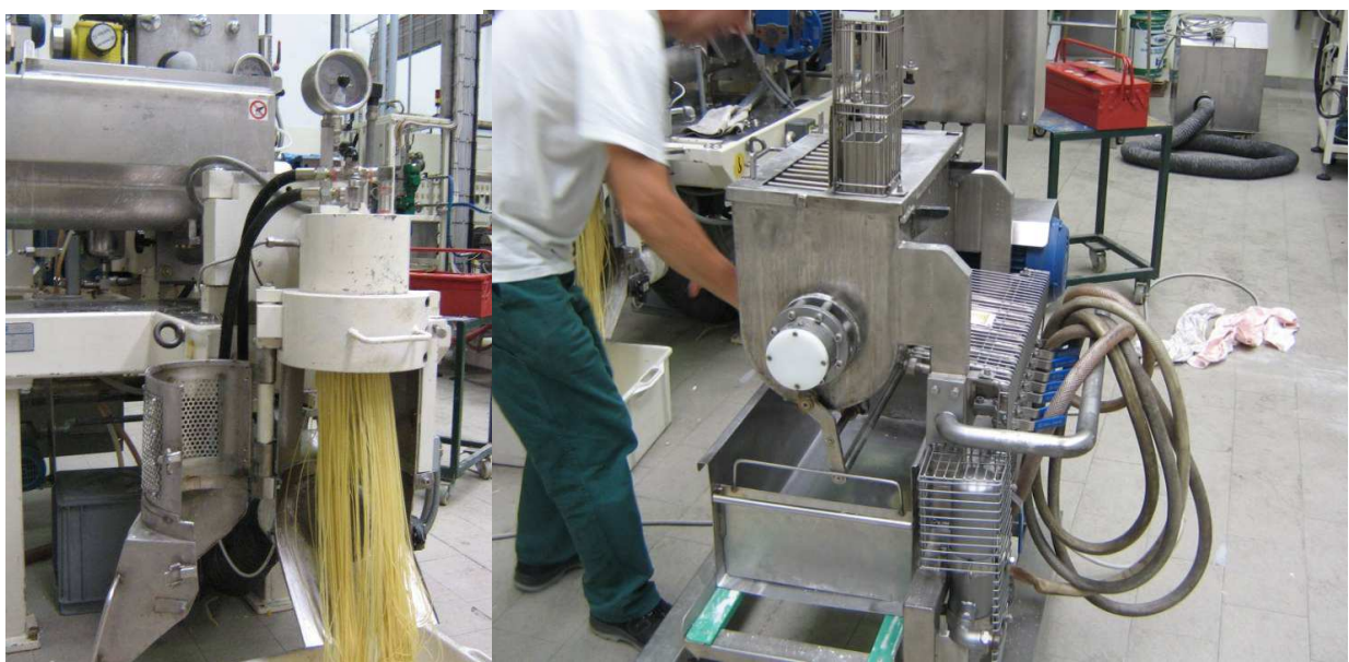
Figura 2.6 Impianto pilota per la produzione di spaghetti da 1,5 mm.
