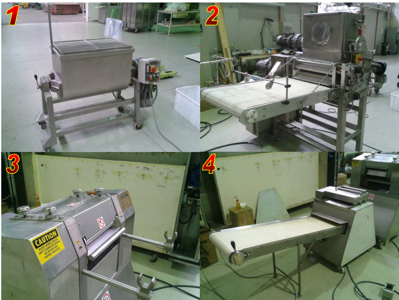
Figura 2.5 Impianto pilota per la produzione di fettuccine da 2mm.
