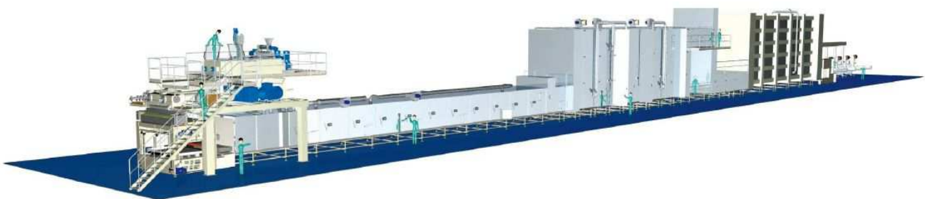
Figura 2.1 Layout di un impianto industriale completo per la produzione di pasta lunga.
