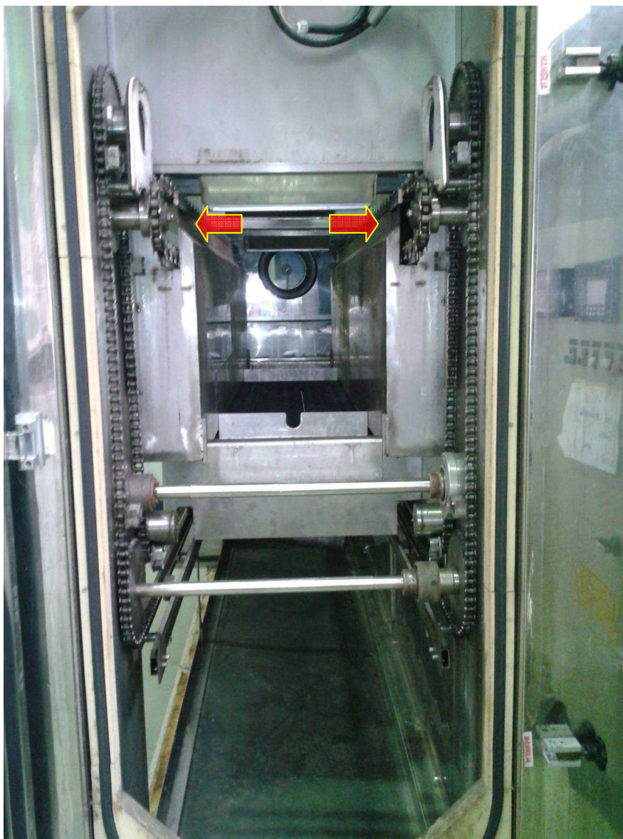
Figura 3.13 Vista frontale dell'impianto pilota a porte aperte . Le frecce indicano la variazione di sezione nella zona di essiccazione.
