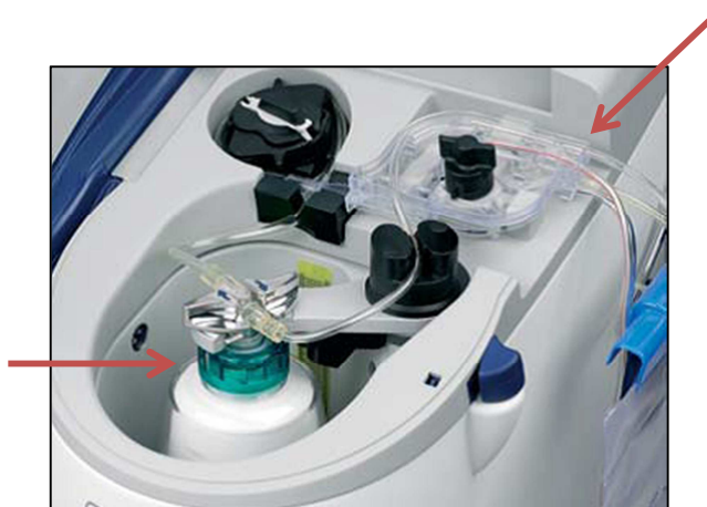
Figura 2.3: Sistema per autotrasfusione sviluppato da Sorin Group Italia. È possibile distinguere la bowl e la pompa peristaltica con i rispettivi canali.
