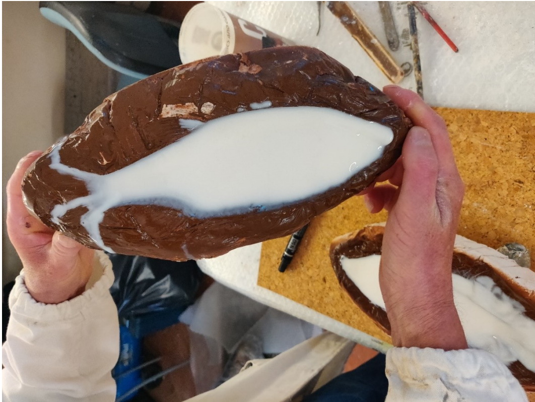
Fig. 2.9 Realizzazione modello in poliuretano (foto di Anna Massignan)
