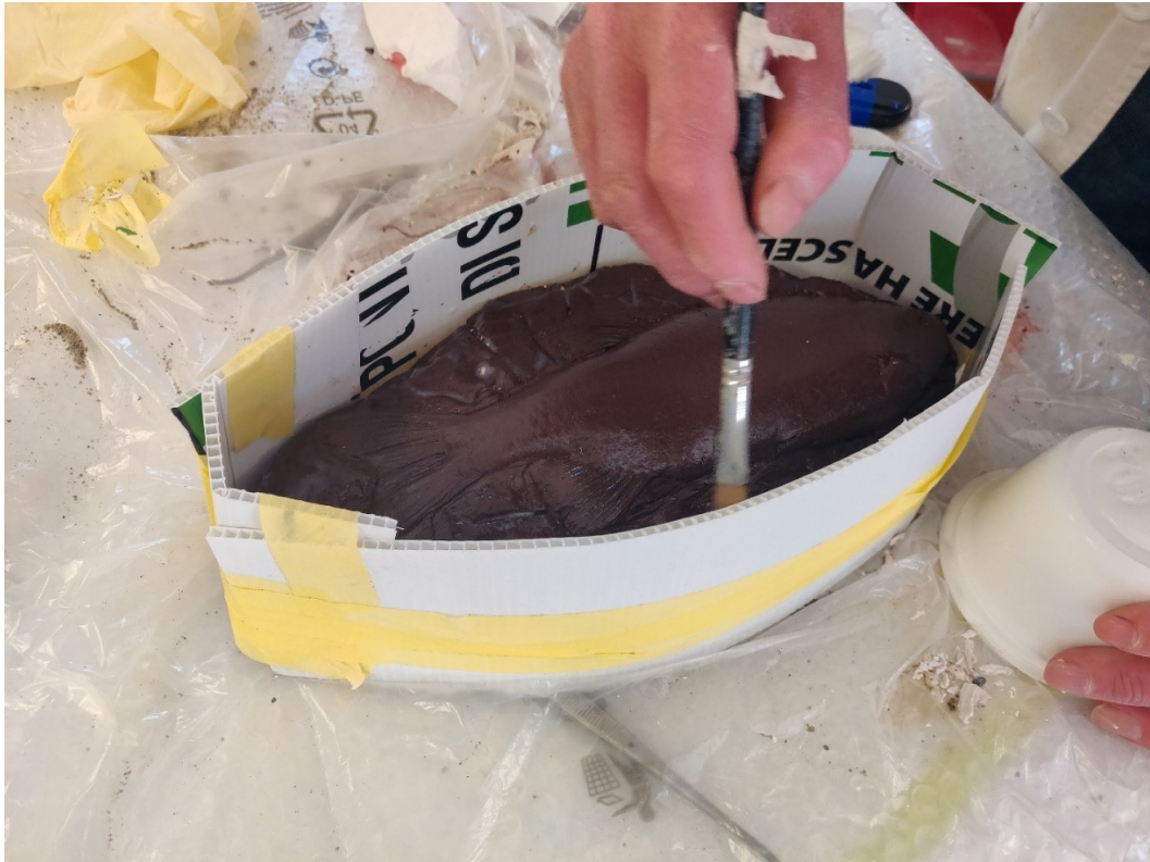
Fig. 2.8 Stesura di uno strato di cera sulla superficie del pesce (foto di Diego Zanobini)
