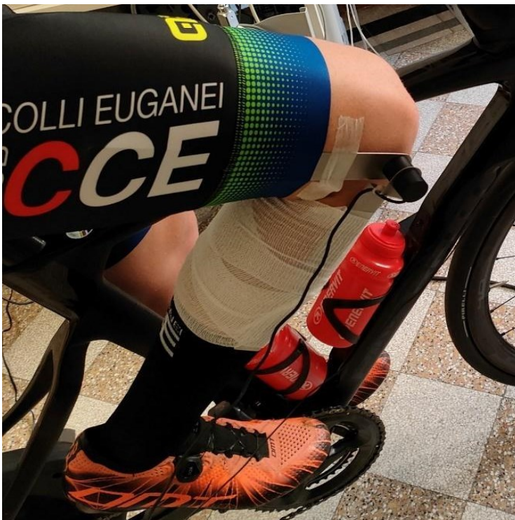
Figura 2.7 Immagine dell'elettrogoniometro posizionato con il fulcro sul condilo laterale del femore del soggetto durante il test sul cicloergometro
