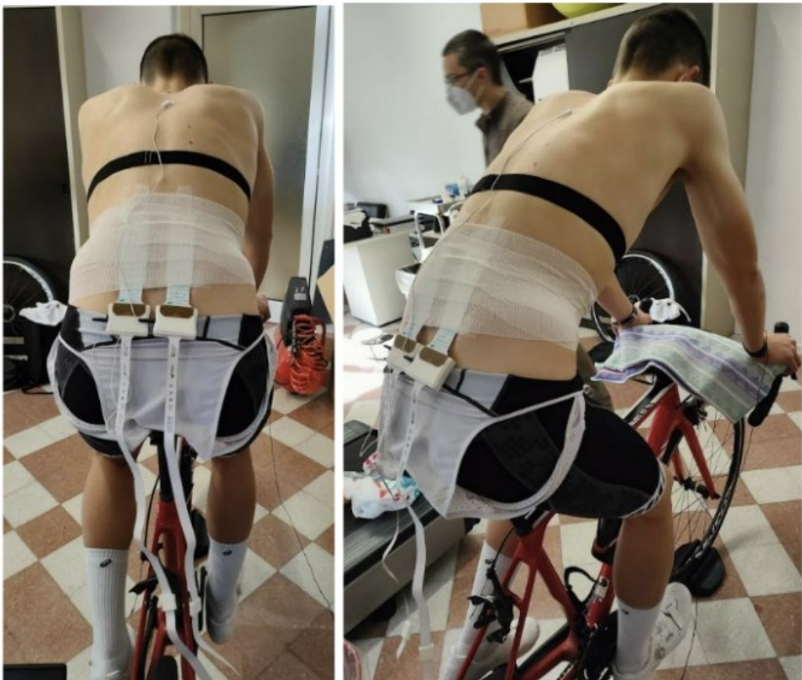
Figura 2.9 Ciclista in sella alla propria bici da corsa posizionata sul rullo interattivo Elite Direto XR, con le due matrici di elettrodi poste 2 cm lateralmente rispetto ai processi spinosi lombari a partire dall'altezza delle creste iliache
