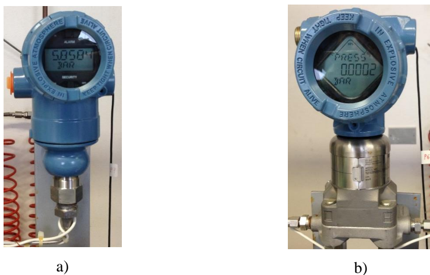
Figura 3.8: a) misuratore di pressione assoluto; b) misuratore di pressione differenziale.
