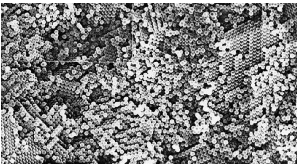
Figura 1.2. Microstruttura della silice colloidale.
