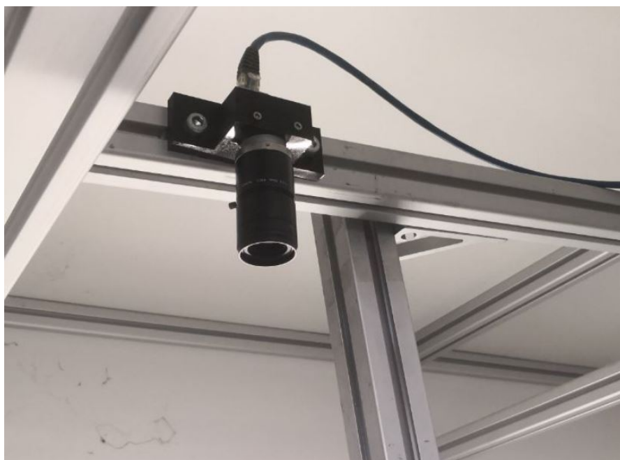
Figura 4.5: Fotocamera per l'acquisizione della posizione robot e del carrello
