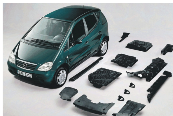
Fig 3.7 a sinistra, Mercedes-Benz classe S: componenti in fibra naturale
