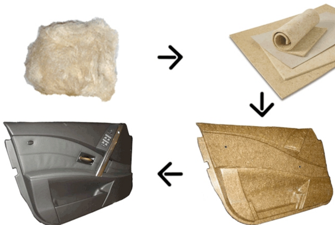
Fig. 3.6 Fasi produttive di un materiale composito con fibre naturali
