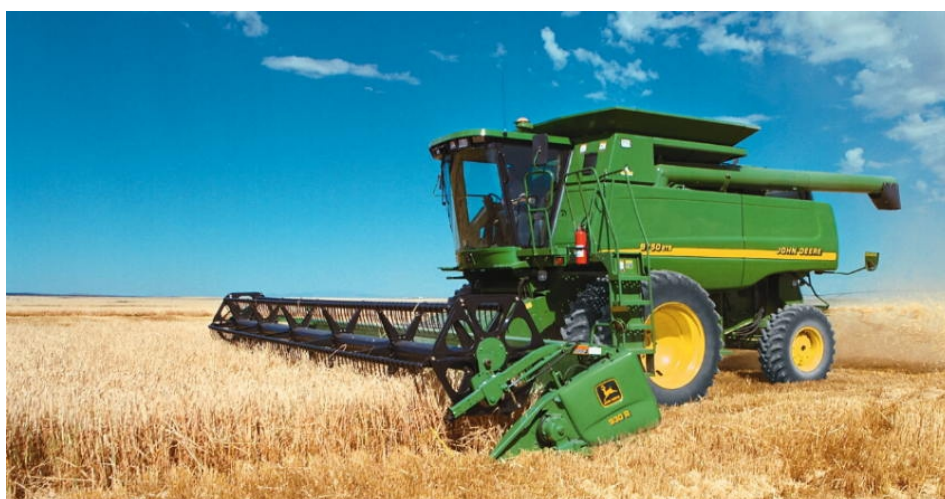
Fig. 3.14 Mietitrebbiatrice John Deere con carene e pannelli rinforzati con fibre naturali
