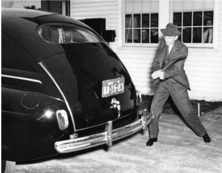
Fig. 3.5 H. Ford dimostra la resistenza di un'autovettura realizzata in canapa e resina di soia
