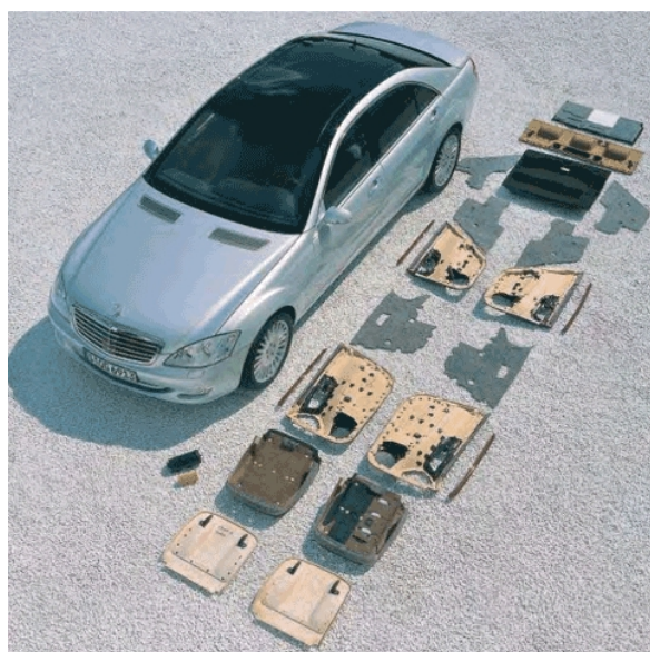
Fig 3.7 a sinistra, Mercedes-Benz classe S: componenti in fibra naturale
