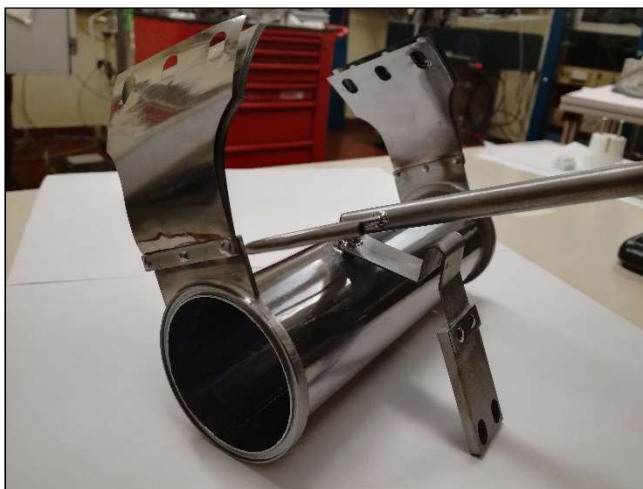
Figura 2.3: Foto del riscaldatore in tantalio
