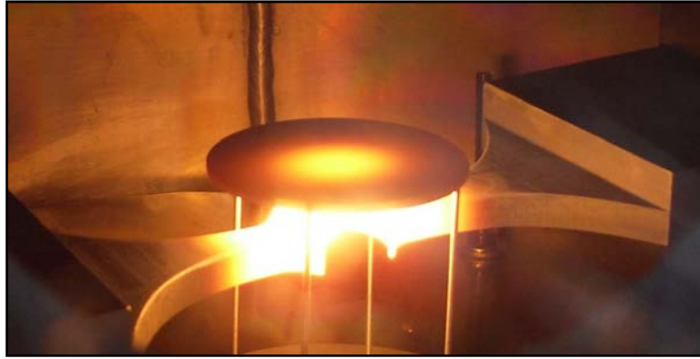
Figura 3.2: Modalità di generazione dei gradienti termici radiali. Il riscaldatore trasmette il calore per irraggiamento concentrandolo sul centro del disco creando così una disomogeneità nella distribuzione della temperatura
