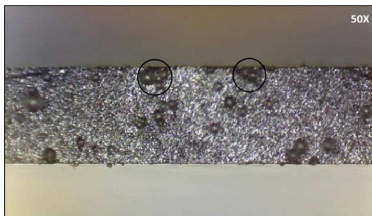
Figura A.32: Superficie di frattura di un disco in carburo di silicio Hexoloy SP di diametro 40 mm e spessore 0,5 mm. Ingrandimento a 50X. Con i cerchi neri si identificano i possibili difetti. La rottura è stata raggiunta a 143 MPa.
