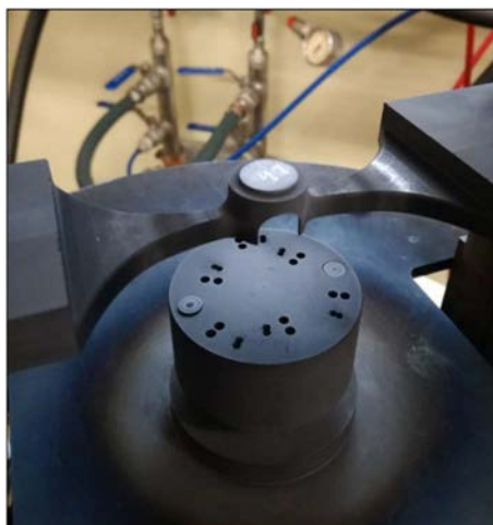
Figura 7.13: Rappresentazione del posizionamento del disco sul riscaldatore in grafite per portarlo a temperature elevate
