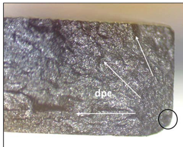
Figura A.17: Superficie di frattura di un disco in carburo di silicio Hexoloy SA di diametro 40 mm e spessore 1 mm. Ingrandimento a 50X. Con il cerchio nero si identifica la posizione del difetto mentre con le frecce bianche si indica la direzione di propagazione della cricca (dpc). La rottura è stata raggiunta a 418 MPa.
