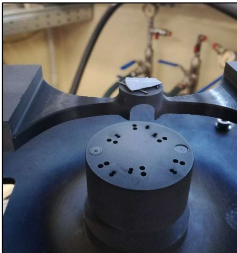
Figura 7.15: Rappresentazione del posizionamento del frammento di disco sul riscaldatore in grafite per portarlo a temperature elevate
