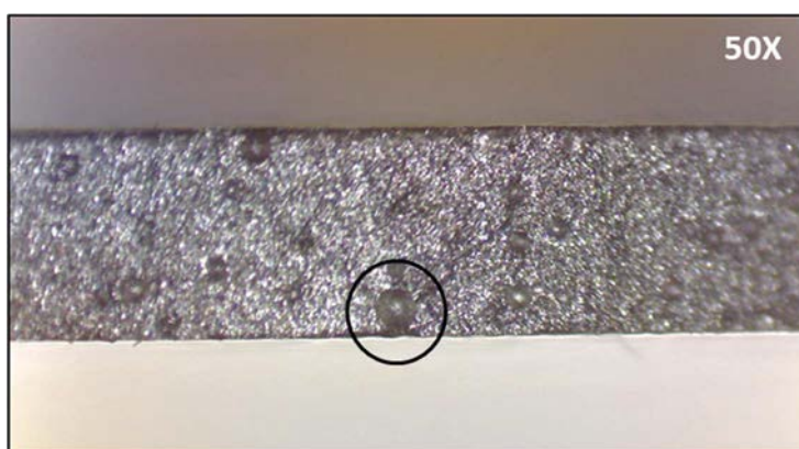
Figura A.33: Superficie di frattura di un disco in carburo di silicio Hexoloy SP di diametro 40 mm e spessore 0,5 mm. Ingrandimento a 50X. Il cerchio nero evidenzia il difetto innescante la cricca. La rottura è stata raggiunta a 159 MPa.
