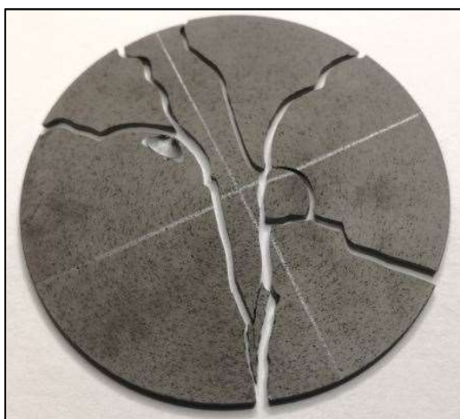
Figura 6.14: Tipica frattura a "fontana" in un disco di SiC SP generata da un forte gradiente termico
