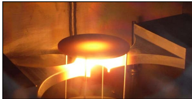
Figura 5.40: Modalità di riscaldamento dei dischi. Apparato sperimentale presente nel laboratorio di Alta Temperatura
