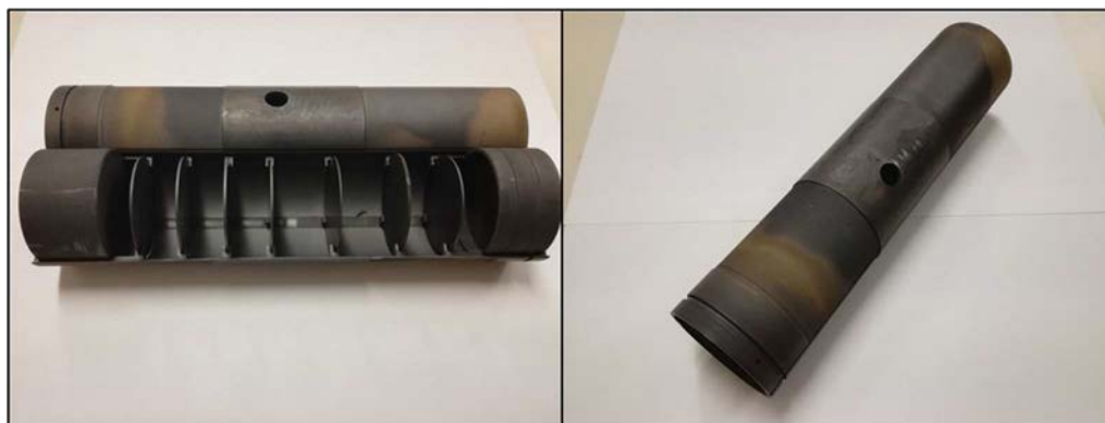
Figura 2.2: Foto del target SPES, esempio di disposizione dei 7 dischi e posizione del foro per l'estrazione degli isotopi prodotti
