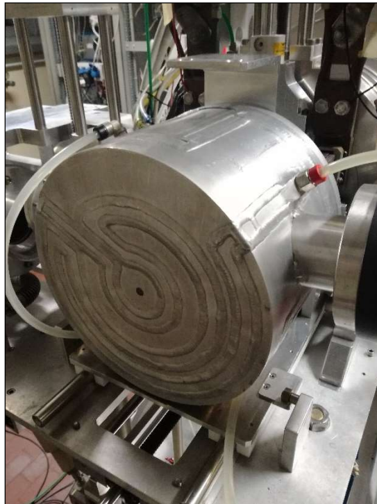
Figura 2.8: Foto del coperchio che delimita il volume in alto vuoto della camera target
