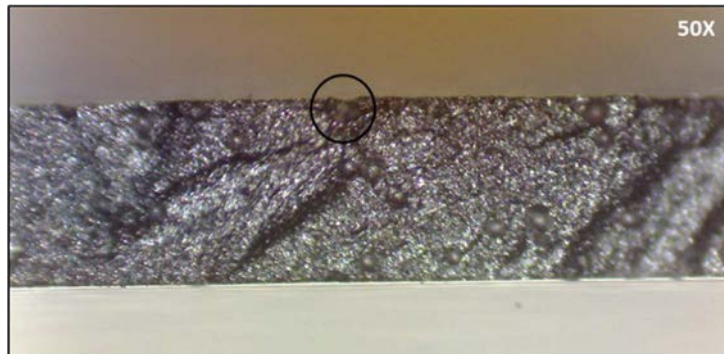
Figura A.31: Superficie di frattura di un disco in carburo di silicio Hexoloy SP di diametro 40 mm e spessore 0,5 mm. Ingrandimento a 50X. Il cerchio nero evidenzia il difetto innescante la cricca. La rottura è stata raggiunta a 152 MPa.
