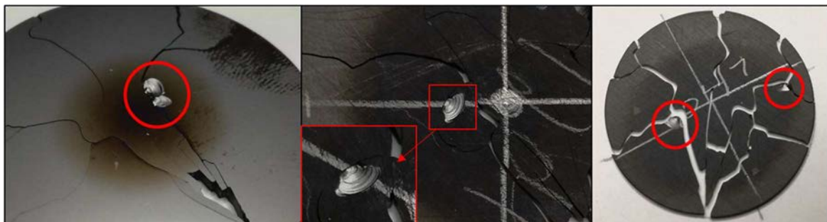
Figura 5.50: Fenomeno di Chipping sul bordo della superficie di frattura di dischi in SiC SA
