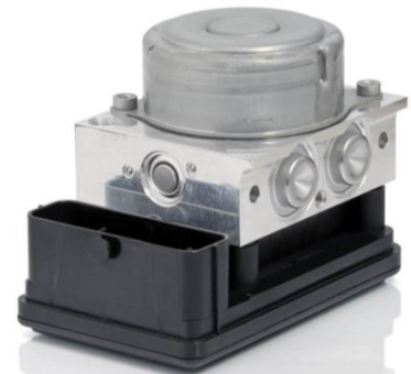
Figura 6: Pompa del sistema ABS
