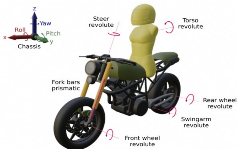
Figura 9: ROLL e PITCH nel motociclo
