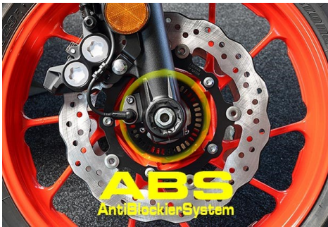
Figura 5: Sistema rilevazione velocità ruota
