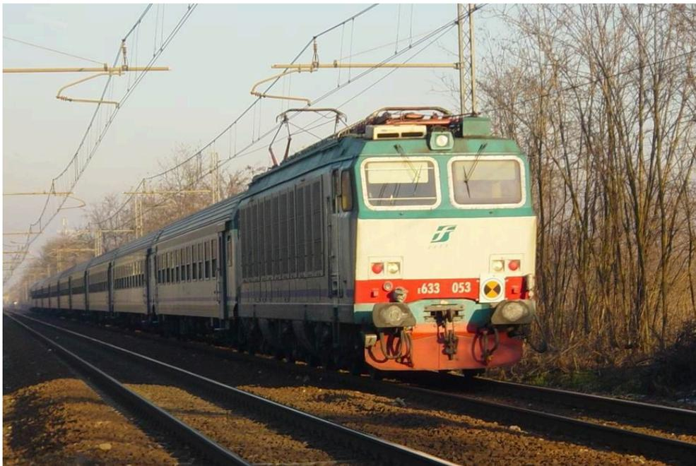
Le E.632 non sono dotate di cassa articolata, come in genere le altre locomotive delle serie E.6xx. La cassa è a struttura portante, con telaio unico realizzato con una griglia di travi scatolate.
