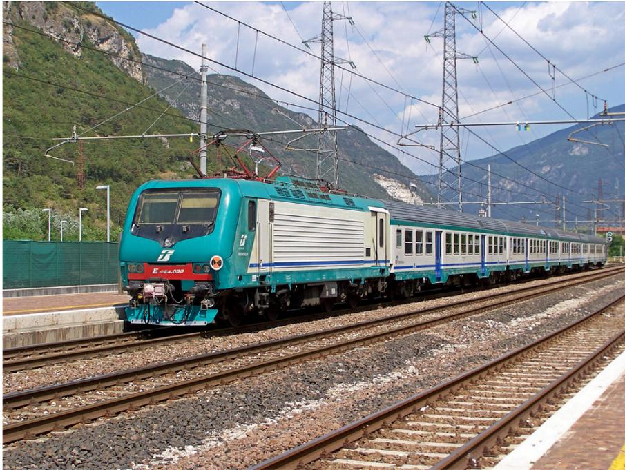
Le E.464 furono dotate, per la prima volta in Italia, di un sistema di accoppiamento automatico in grado di unire o separare rapidamente due motrici per creare treni composti da due convogli distinti. La struttura della cassa è compatta e leggera, con struttura portante in lamiera d'acciaio grecata e tetto in alluminio.
