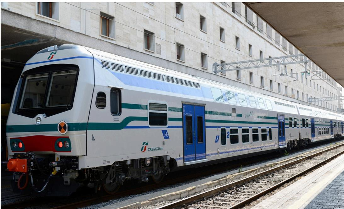
I treni in composizione Vivalto sono generalmente composti da una locomotiva E.464, 4 carrozze Vivalto e una carrozza Vivalto semipilota. Per estensione viene chiamato Vivalto l'intero convoglio (locomotiva + carrozze + carrozza semipilota).
