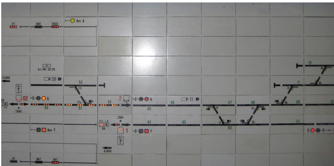
Gli Apparat Centrali Computerizzati rappresentano l'evoluzione degli ACEI e si basano su un uso spinto dei calcolatori elettronici e tecnologie informatiche per agevolare ed ottimizzare le scelte dell'operatore.
