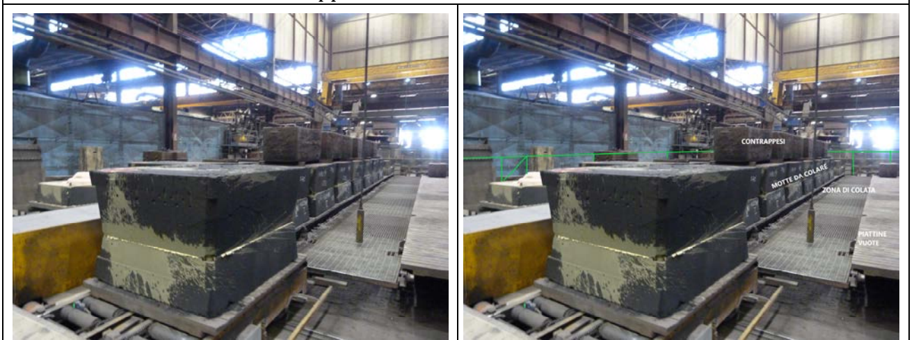
Carrello trasferitore della zona di colata con motta da trasferire sulle rulliere di colata
