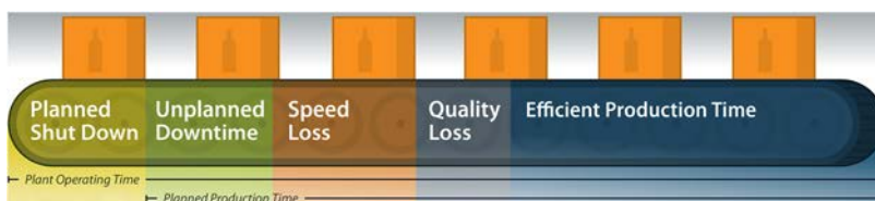
Figura 65 - Tempo di produzione efficiente reale, eliminando cioè sia i downtime programmati e non programmati, sia il tempo perso per perdita di velocità o qualità (tratto dalla brochure di Inductive Automation)
