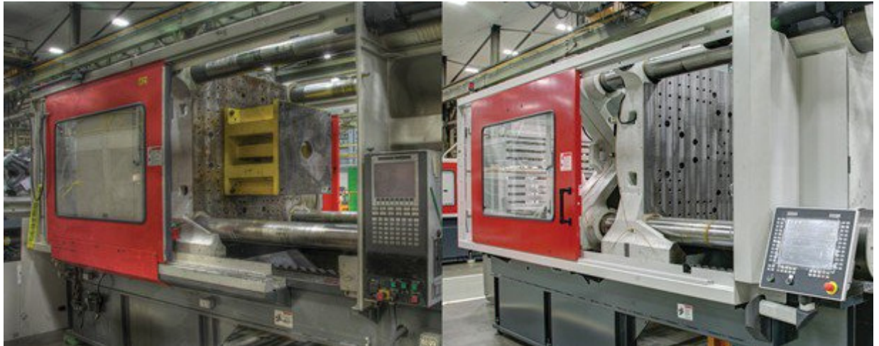
Figura 20 - Chiaro esempio di revamping: i componenti originali sono stati sostituiti con nuovi componenti con caratteristiche simili, mentre è stato sostituito completamente solo il sistema di comando (tratta dal web)
