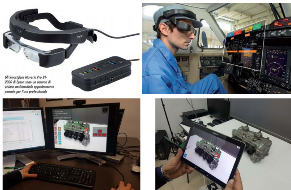
Figura 63 - Nelle due figure in alto, manutenzione in AR tramite smartglass (tratte dall'articolo "L'operatore 2.0 grazie alle tecnologie indossabili" di Franco Canna sulla rivista Automazione e Strumentazione, n°9, Anno LXIII); nelle due figure in basso, manutenzione in AR mediante supporto tecnico da remoto con tablet (tratto dall'articolo di Masoni et al. riportato in bibliografia)
