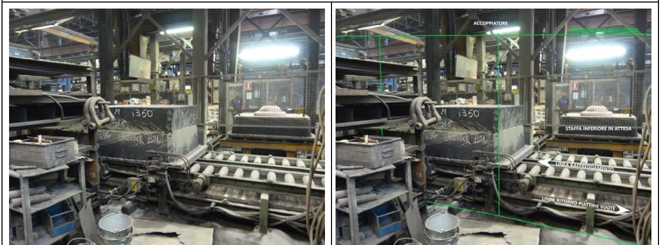
Vista dell'accoppiatore dalla linea di raffreddamento e vista della linea di ritorno piattine
