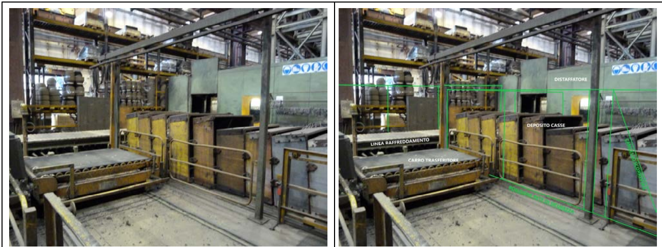
Carrello trasferitore zona di formatura con distaffatore sullo sfondo
