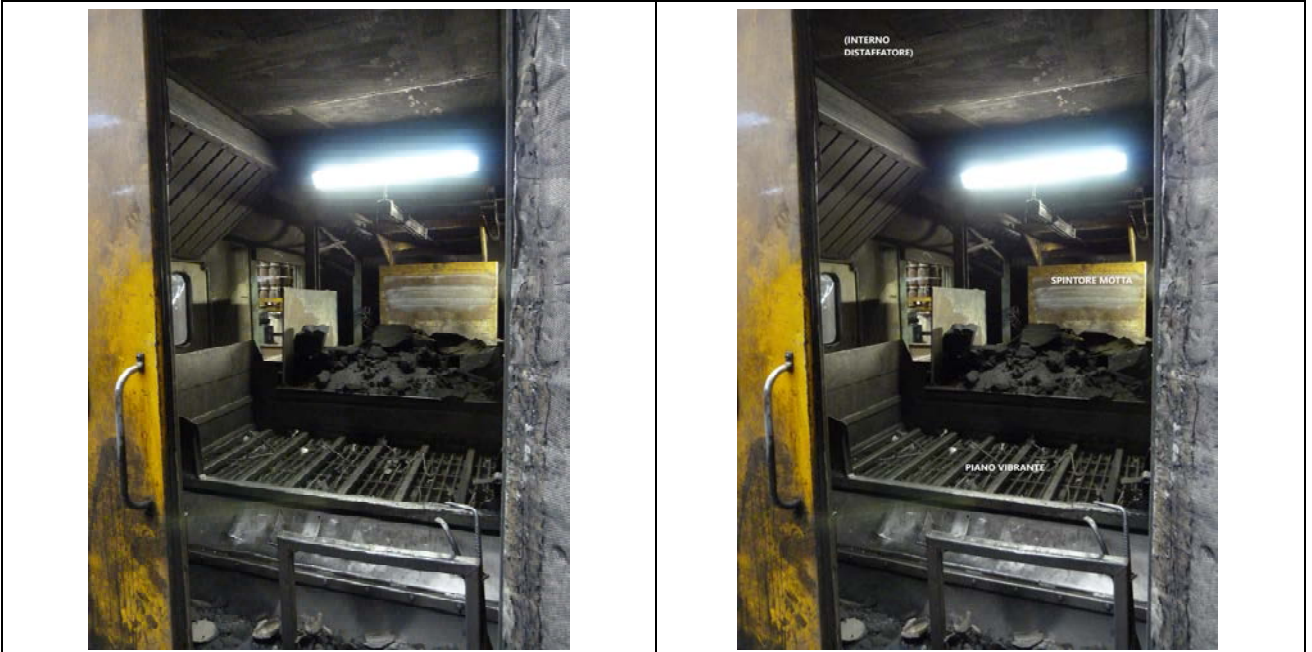
Interno del distaffatore visto dalle porte frontali
