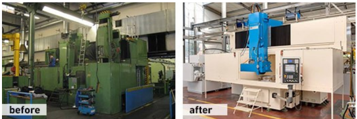
Figura 22 - Un esempio di retrofitting: la macchina nuova non ha nulla a che vedere con l’originale in quanto quasi tutti i componenti sono stati rimossi e rimpiazzati con attrezzature con funzioni aggiuntive (tratta dal web)
