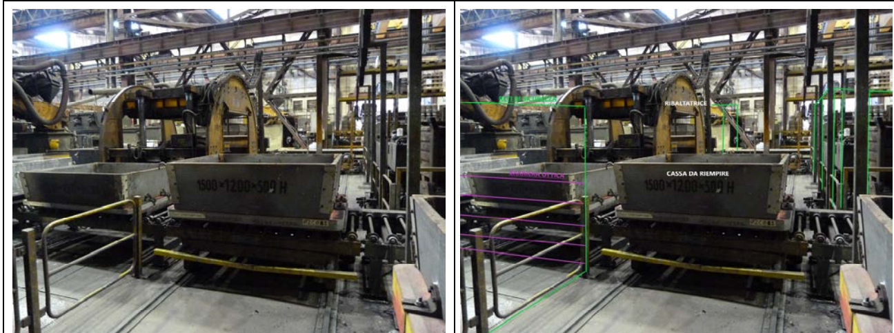
Carrello trasferitore della zona di formatura e ribaltatrice sullo sfondo
