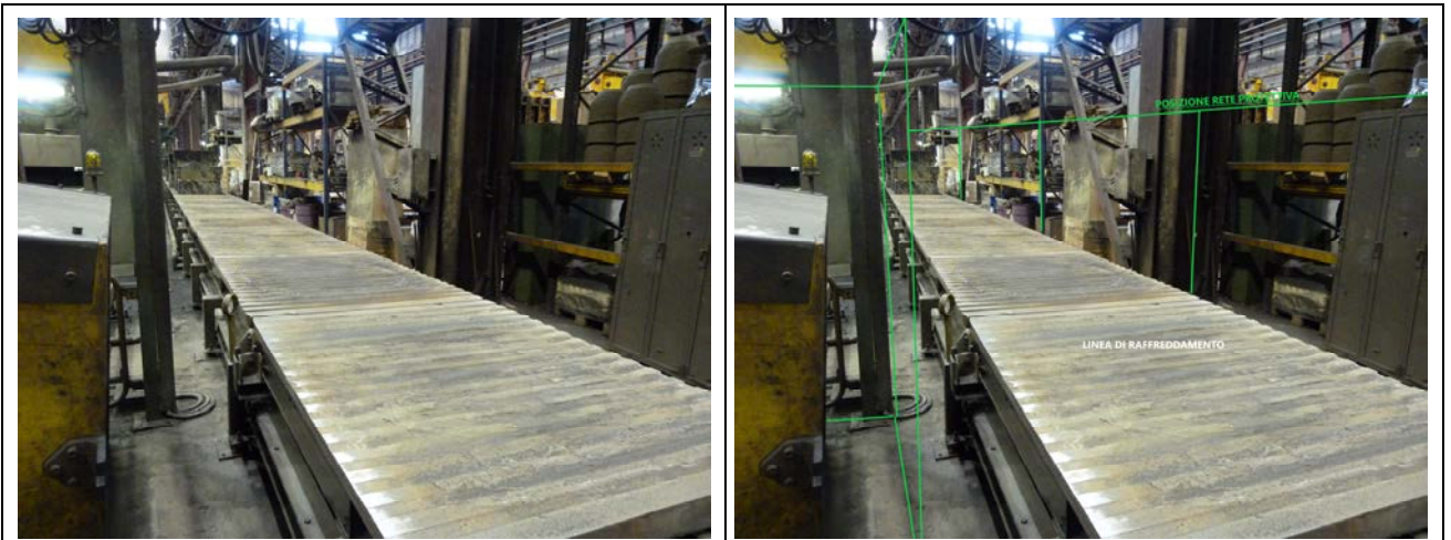
Piattine vuote da immettere nella linea di ritorno, in prossimità del distaffatore
