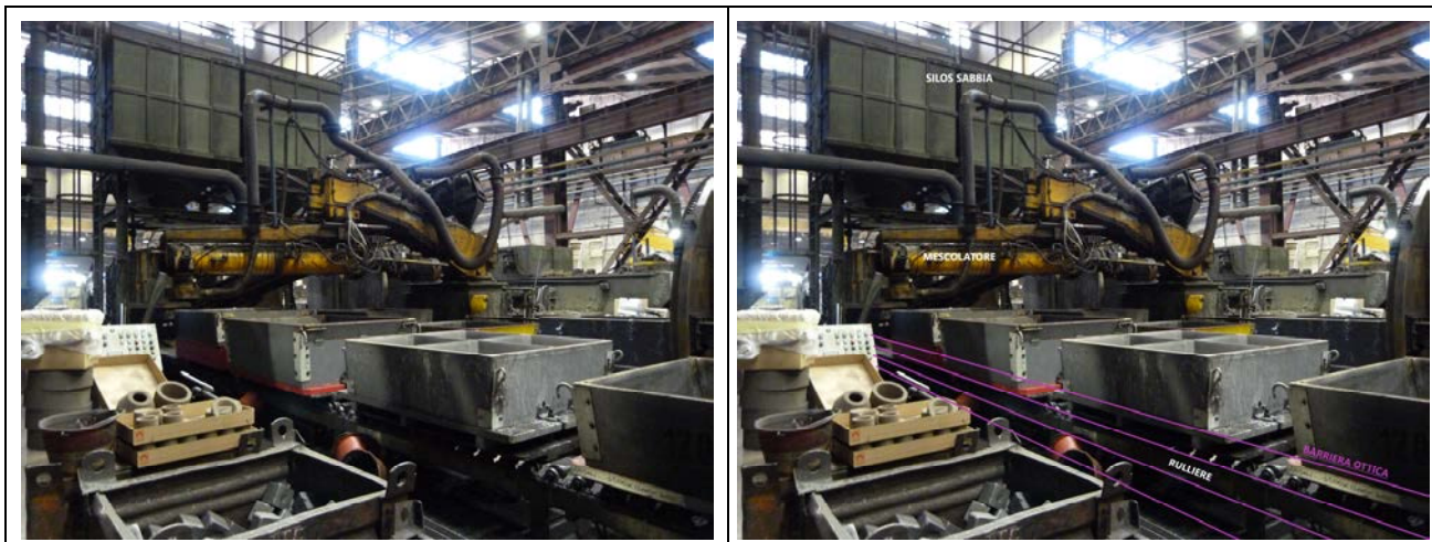
Zona di formatura con mescolatore, rulliere, piano vibrante e silos sabbia e resine
