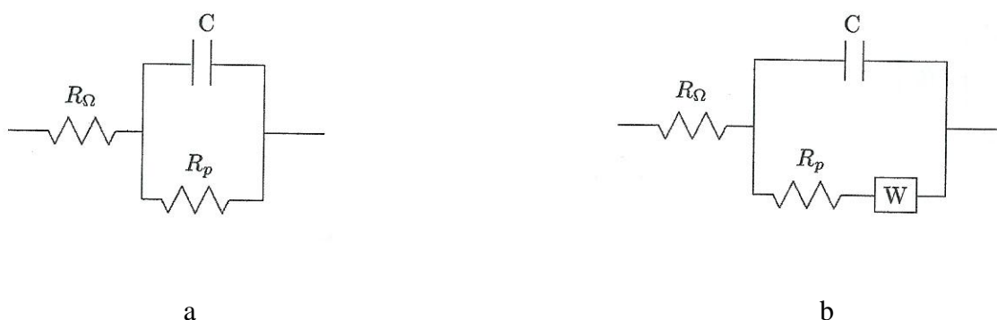
Figura 5.3 - Circuito equivalente di un fenomeno di corrosione per semplice attivazione (a) e di uno strato semplice con parziale controllo diffusivo (b)
