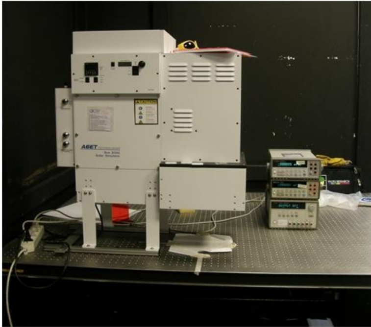
Figura 3: Simulatore solare ABET Technologies Sun 2000 utilizzato per la caratterizzazione delle celle.
