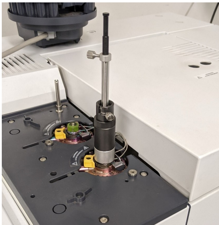
Figura 2: fase di desorbimento nell'iniettore
