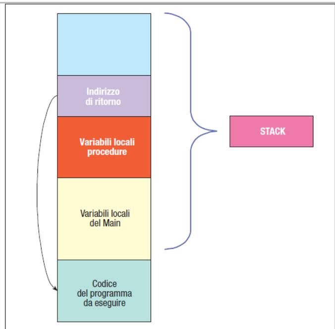
Figura 3.27: Stato dello stack in seguito all'inserimento di una stringa contenente il codice eseguibile di un programma
