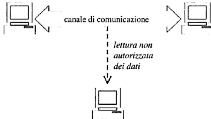
Figura 3.14: Schema funzionamento attacco di tipo Sniffing
