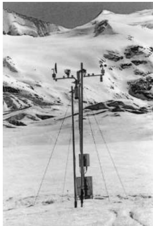
Figura 11 Stazione AWS sul Vadret da Morteratsch
