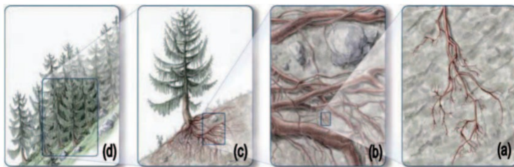
Figura 3 Illustrazione in ordine di grandezza del rinforzo radicale considerando scale che vanno dalla singola radice al popolamento forestale: (a) scala della singola radice; (b) scala di un fascio di radici; (c) sistema radicale di un singolo albero; e (d) scala di un popolamento forestale su un versante. (Immagine tratta da Schwarz et al., 2010; recuperabile presso l'indirizzo online: www.interscience.wiley.com/journal/espl )
