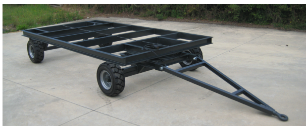
Figura 1.3: telaio di un carro a 4 ruote
