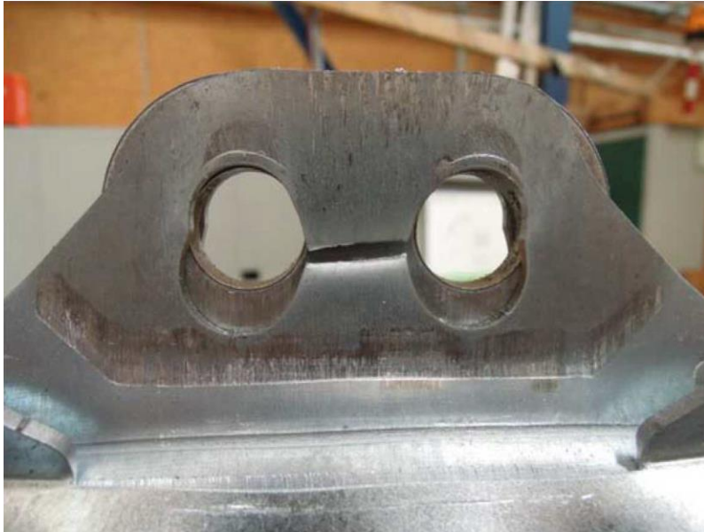
Immagine 4.34: meccanismo di rottura per block tearing contemporaneo di box metallico e piastra interna.
