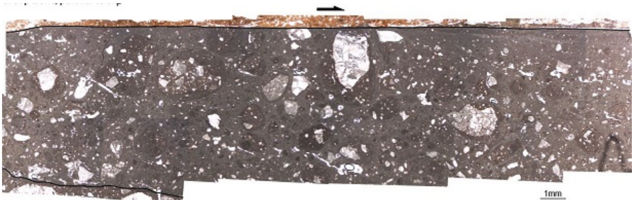
Figura 4. Fotomosaico di immagini al microscopio ottico, è un ingrandimento del Grain Cortex Layer della sezione sottile 54B.
