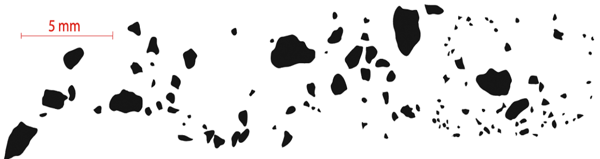
Figura 5. Immagine dei clasti centrali presenti nel Fotomosaico ottenuta in seguito alla mappatura in Adobe Illustrator.
