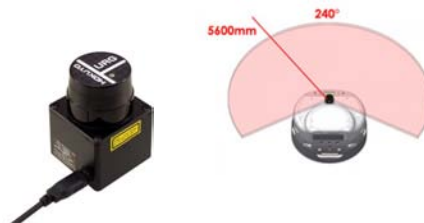
Figura 2.7: sensore SOKUIKI: sensore laser con un campo visivo di 240 gradi e un raggio massimo di 5600 mm [28].
