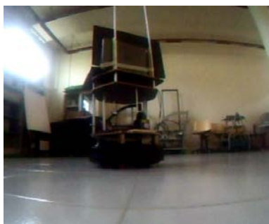
Figura 4.2: Il robot è stato dotato di telecamera, lo stream è stato visto dall'utente direttamente sul suo computer. Inoltre ha potuto dare un comando “gira a sinistra” o “gira a destra” e ha ricevuto il feedback .
