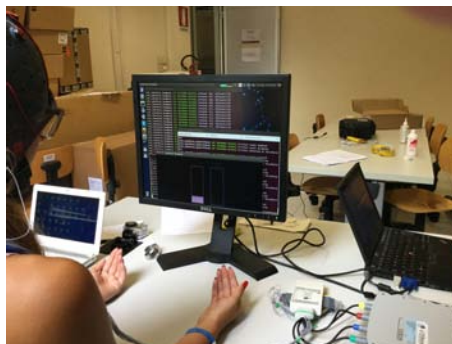
Figura 4.4: Fase di training: ho dovuto immaginare di aprire e chiudere la mano destra e sinistra, ma senza compiere effettivamente il movimento. Dopo aver analizzato la mia attività cerebrale, processato i segnali e successivamente classificati, è stata verificata la correttezza del modello: mediante l'immaginazione del movimento richiesto dovevo inviare il comando corretto.
