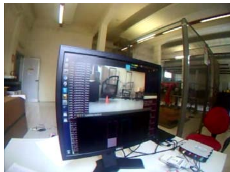
Figura 4.2: Il robot è stato dotato di telecamera, lo stream è stato visto dall'utente direttamente sul suo computer. Inoltre ha potuto dare un comando “gira a sinistra” o “gira a destra” e ha ricevuto il feedback .
