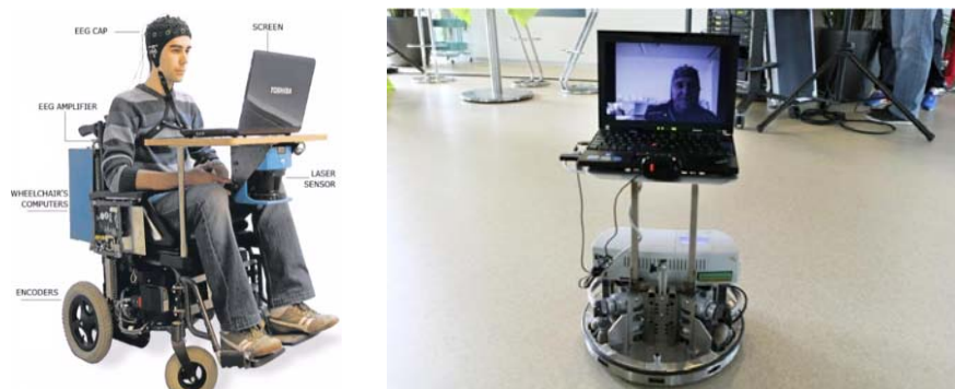
Figura 1.6: Telepresenza: grazie all'analisi dell'attività cerebrale svolta dalla BCI si riesce a controllare una sedia a rotelle o a guidare un robot mobile [12].
