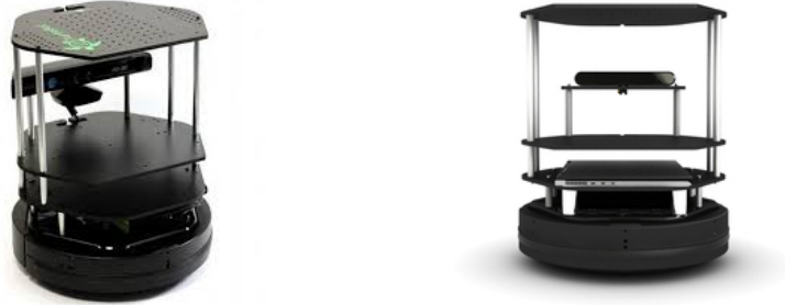
Figura 2.6: TurtleBot 2 visto lateralmente e posteriormente.
