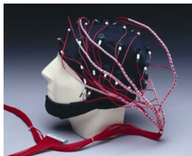
Figura 2.2: Cuffia con gli elettrodi per l'acquisizione dei segnali elettrici provenienti dal cervello.
