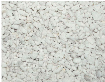
Figura 7: Forma e dimensione della perlite, lavorata e frantumata in pezzi piccoli. [10]
