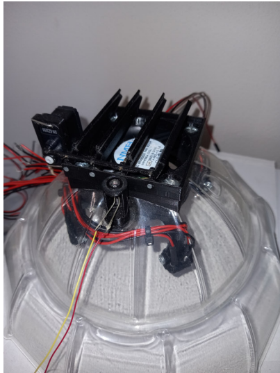
(a) Deflettori e relativo collegamento al servomotore
