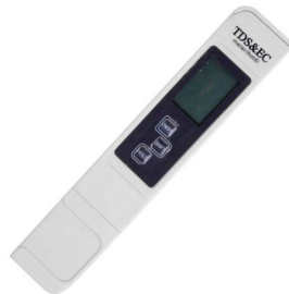
Figura 12: Strumento digitale per la misurazione del valore di EC nei liquidi.
