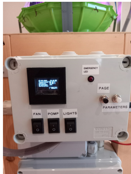
(b) Pannello di controllo con dati riportati nel display OLED
