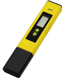
Figura 11: Strumento digitale per la misurazione del pH nei liquidi.
