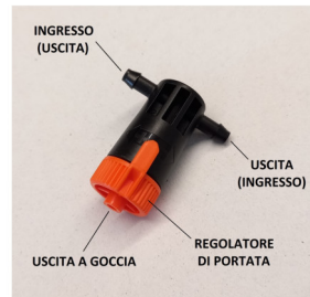
Figura 13: Schema di un gocciolatore usato nella serra: presenta due canali di ingresso/uscita del liquido, a seconda del collegamento e una sola uscita a goccia con valvola arancione per la regolazione del flusso.
