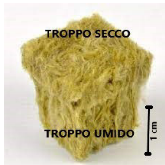
Figura 14: Cubetto in lana di roccia con raffigurate le zone problematiche.
