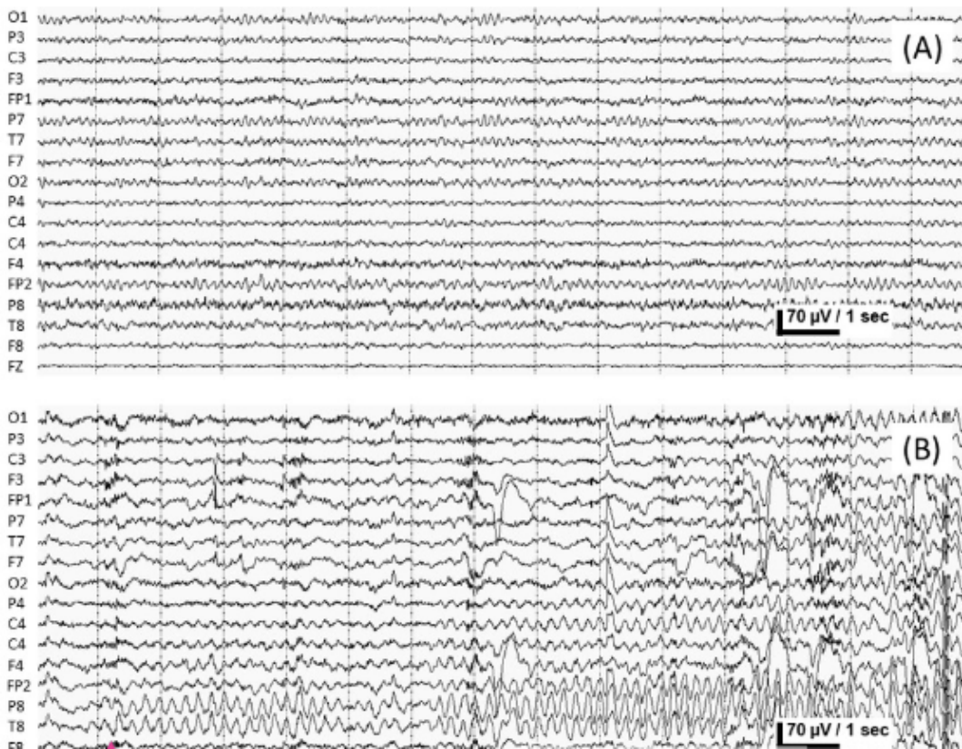
Fig. 3.8: In alto, un tracciato EEG di una persona con attività cerebrale nella norma. In basso, un tracciato EEG di un paziente affetto da crisi epilettiche (in questo caso, generate all'altezza degli elettrodi P8 e T8, dove sono visibili evidenti alterazioni). [12]
