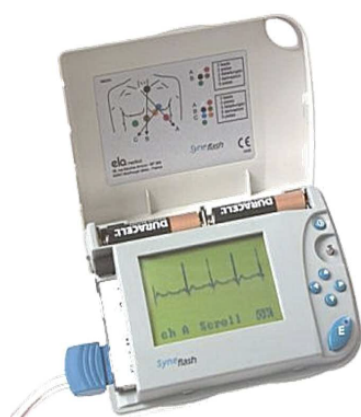
Fig III: Esempio di ECG indossabile per monitoraggio continuo. [9]
