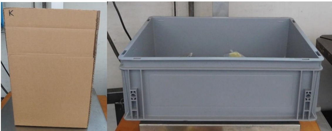
Fig. 2.5: Due dei provini: cartone Kraft e cassetta in polipropilene.
