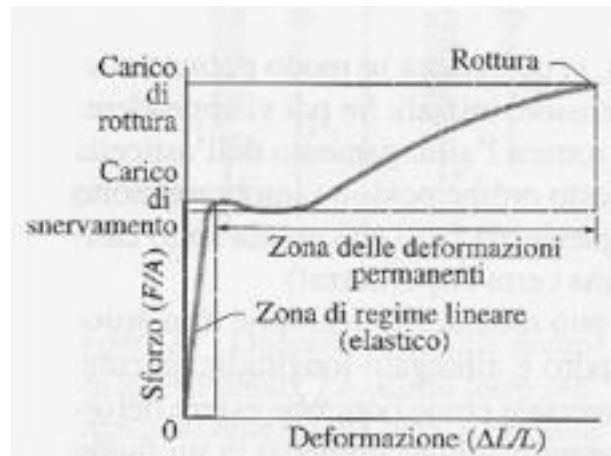
Figura 2.2 Esempio di grafico tensione-deformazione: F = forza di sollecitazione, A = area ortogonale alla forza, L = lunghezza iniziale del campione sotto test, \Delta L = variazione di lunghezza causata dalla sollecitazione
