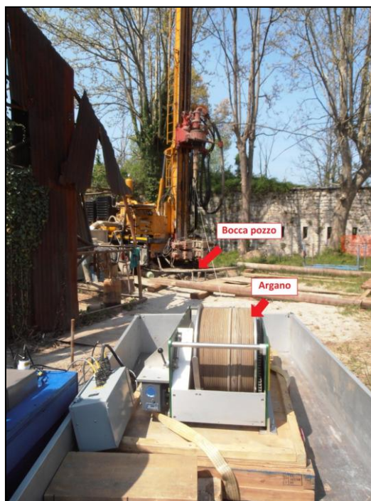
Figura 4.14 – Apparecchiatura utilizzata per le determinazioni geofisiche in foro.
