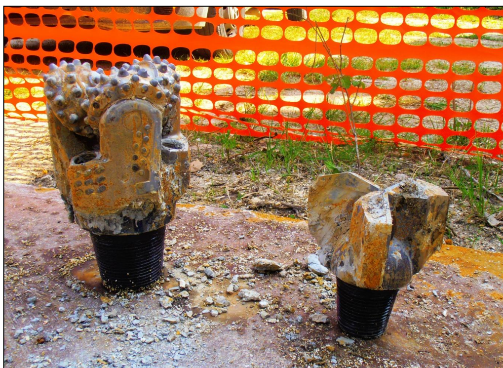
Figura 4.6 – Alcuni degli scalpelli utilizzati: a sinistra uno scalpello a rulli conici dal diametro di 215 mm, a destra uno scalpello a lame dal diametro di 208 mm.
