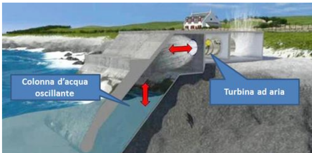
FIG. 5.3 Schematizzazione di un captatore O.W.C.
