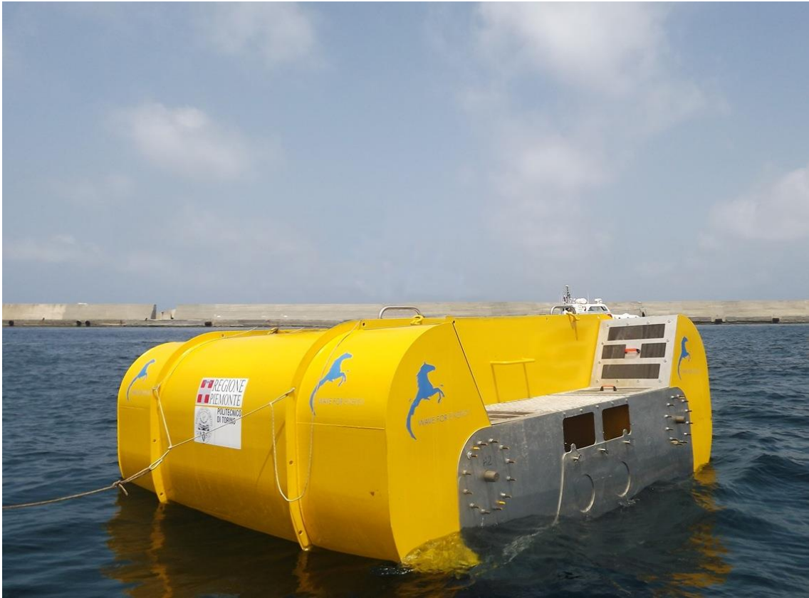
FIG 9.2 Foto del dispositivo ISWEC durante le operazioni di vara a Pantelleria
