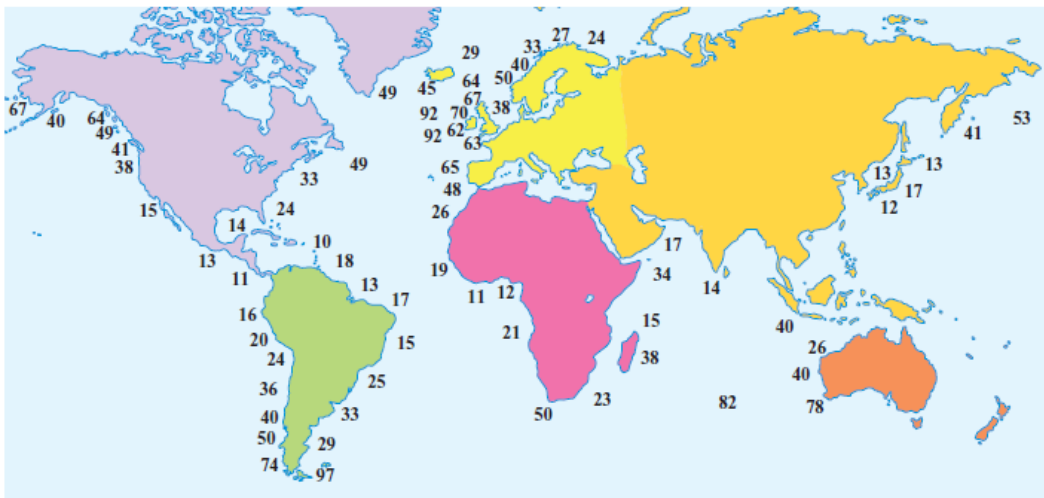
FIG. 4.1 Risorse di energia resa disponibile dalle onde (valori espressi in kW/m).
