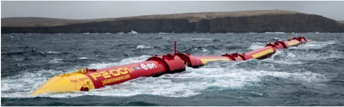
FIG 5.5 Foto di un impianto Pelamis installato a largo delle isole Orcadi.
