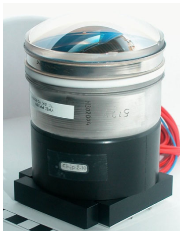
Figura 27: Fotodiode ibrido PHOTONIS da 72 \text{ mm} di diametro [31].
