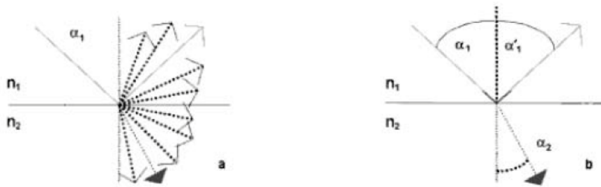
Figura 1.6: a) Superficie irregolare: riflessione e rifrazione diffuse; b) Superficie regolare: riflessione speculare ( \alpha_1 : angolo di incidenza, \alpha'_1 : angolo di riflessione, \alpha_2 : angolo di rifrazione, n_1 : indice di rifrazione del primo mezzo, n_2 : indice di rifrazione del secondo mezzo)
