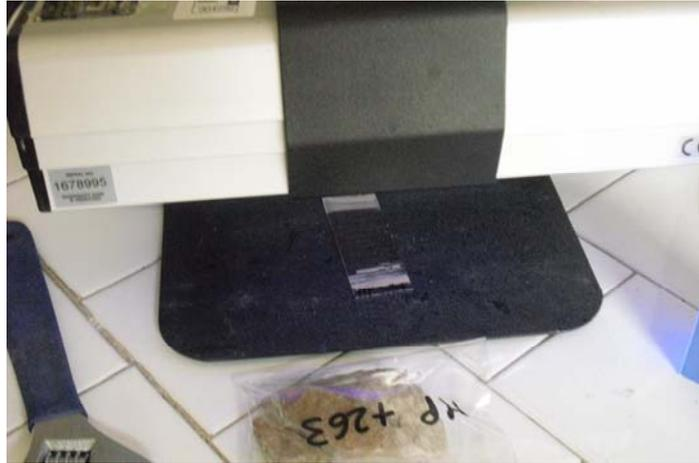
**Fig. 8.8** – Fase di consolidamento della colla sotto la lampada a raggi UV.
