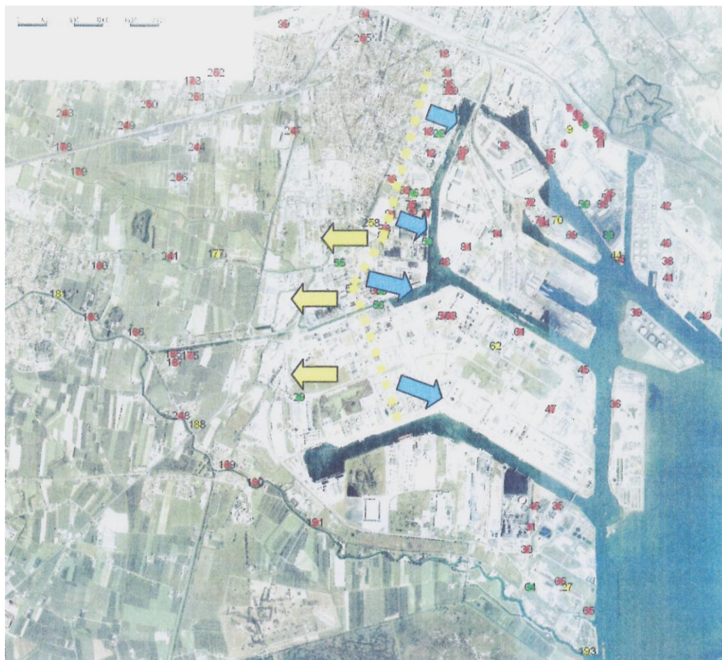
Figura 10 – Direzioni prevalenti di flusso in prima falda. (Technital, 2009)
