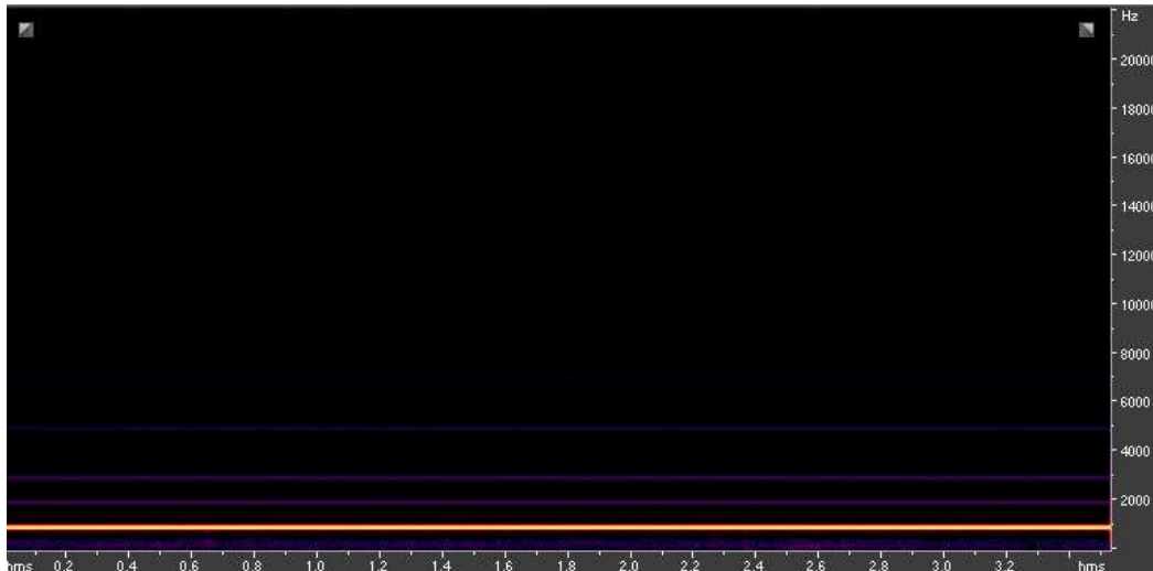
Figura 2.9 Spettrogramma del risultato della calibrazione del fonometro.
