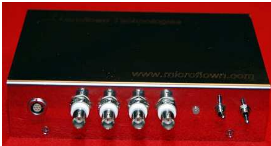
Figura 1.10 Condizionatore di segnale MFSC-4 fornito assieme alla sonda. (tratta da [Bre10])
