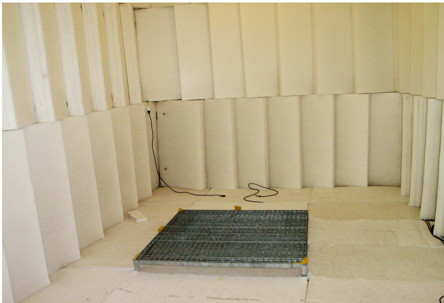
Figura 2.7 Camera fonoassorbente del Laboratorio di Acustica Musicale ed Architettonica
