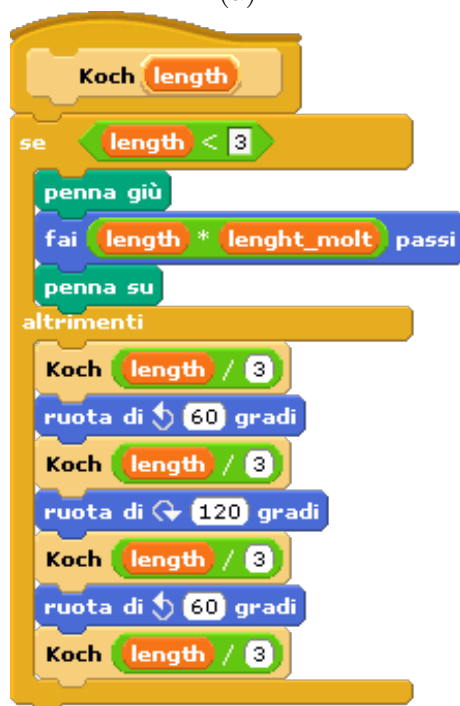
Figura 4.4: Implementazione dell'algoritmo di Koch, adattato alla realizzazione su Scratch/BYOB. (a) Procedura principale (b) procedura ricorsiva
