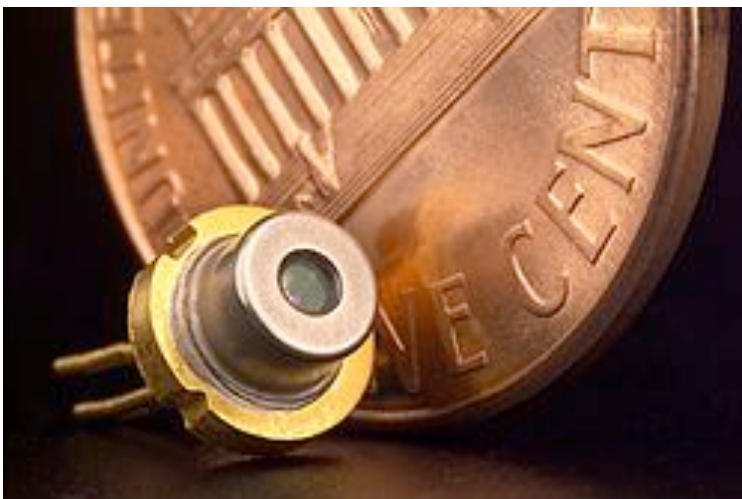
Figura 1.7 diodo laser confrontato con una moneta da un penny per un raffronto di scala
