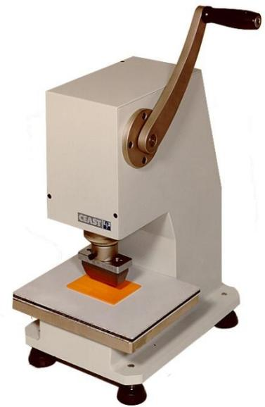
Figura 29 - Pressa manuale per produrre i provini
