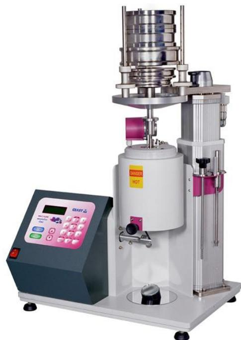
Figura 37 - Strumento di misura di MFR
