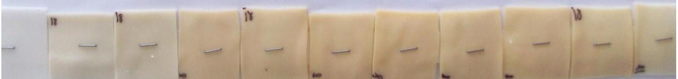
Dalle foto si nota come negli ultimi 3 step del *DINP copertura* vi sia un considerevole degrado improvviso non evidenziato negli altri plastificanti; inoltre nel *plastificante USA copertura* si evidenzia un degrado iniziale già al secondo step che poi però rimane costante e non peggiora nel corso della prova.
