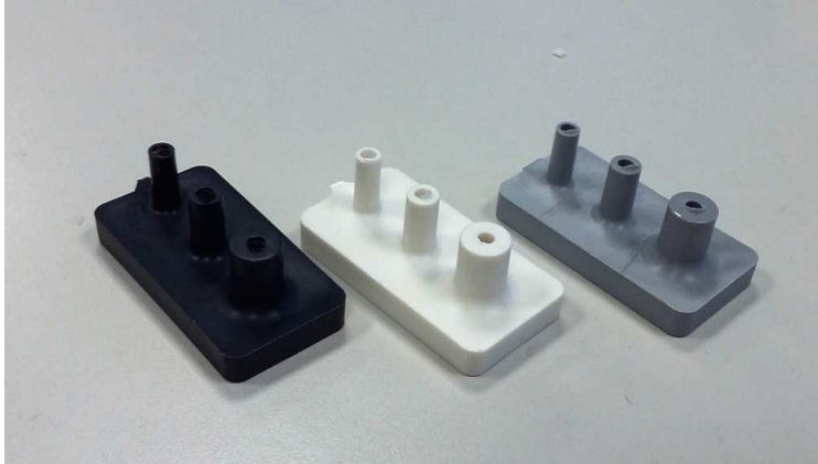
Fig.3.4: supporti per l'avvitatura (poppette) ottenuti per stampaggio ad iniezione
