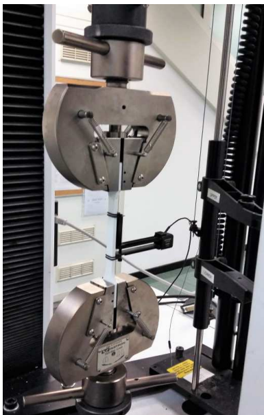
Fig.4.1 macchina per prove di trazione Instron 3366 con cella di carico da 5kN e estensimetri Instron.
