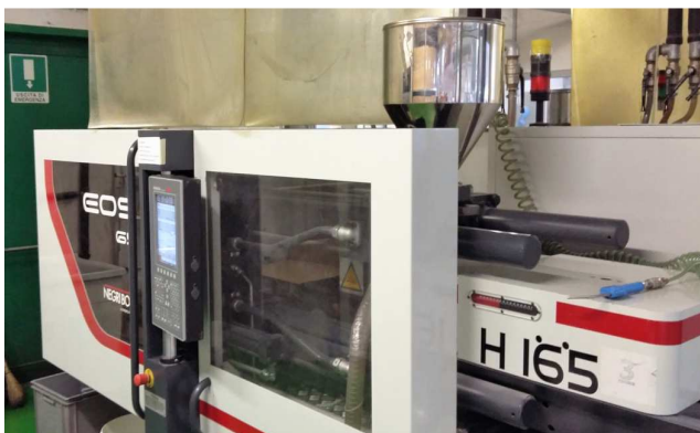
Fig.3.3 pressa idraulica a vite pistonante Negri-Bossi da 65 tonnellate
