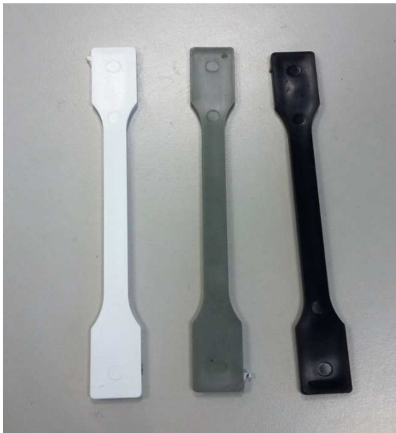
Fig.3.5 provette per trazione ottenute per stampaggio ad iniezione
