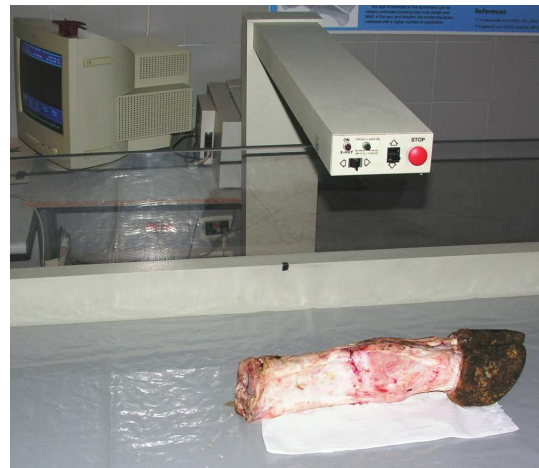
Figura 12 – Esecuzione di esame densitometrico di una sezione di arto posteriore bovino in proiezione dorso-plantare
