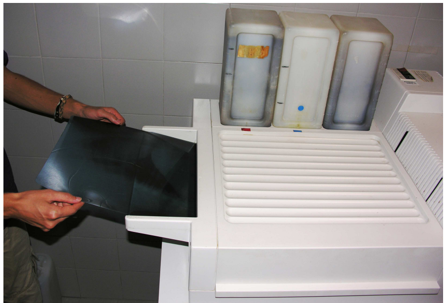
Figura 4 – fase di sviluppo della pellicola radiografica. Inserimento della pellicola nella sviluppatrice automatica
