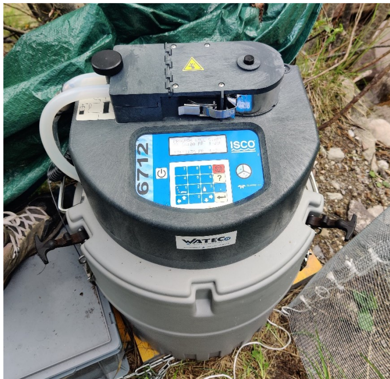
Figura n. 17 Campionatore portatile Teledyne Isco 6712 (1 luglio 2022 ore 14:13).
