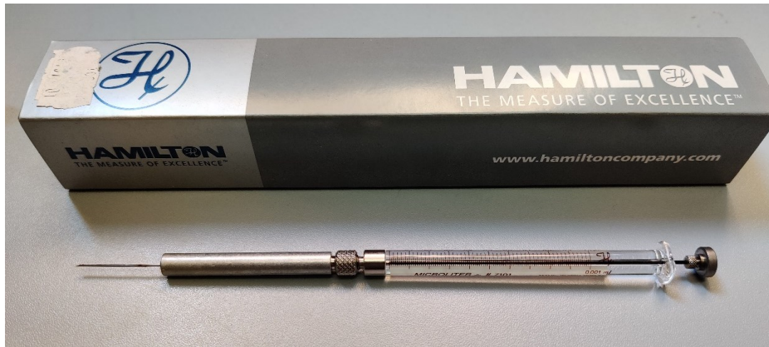
Figura n. 27 Siringa Hamilton, che permette di prelevare fino a 1 \mu l. di campione.
