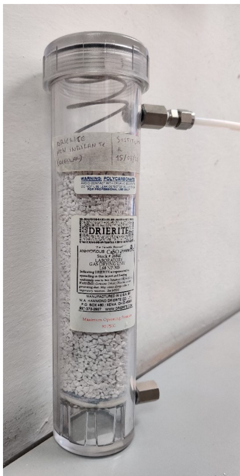
Figura n. 26 Drierite non indicante, sostanza solida granulata, a base di solfato di calcio, utilizzata per rimuovere l'umidità dell'aria in uscita dalla pompa.
