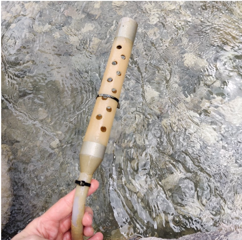
Figura n. 19 Sonda per il prelievo di acqua, dotata di un filtro (1 luglio 2022 ore 14:17).
