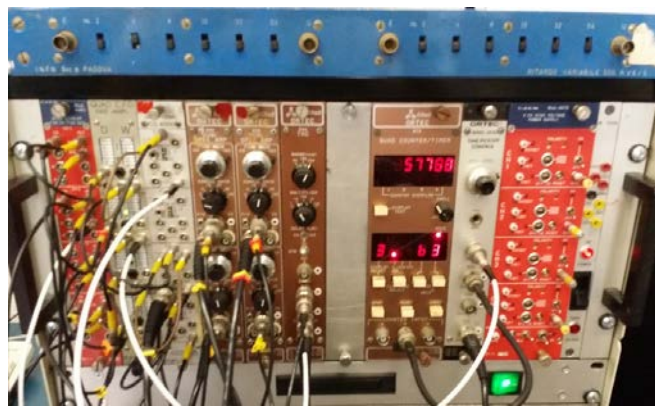
Figura 4. Crate e moduli NIM - Catena elettronica analogica
