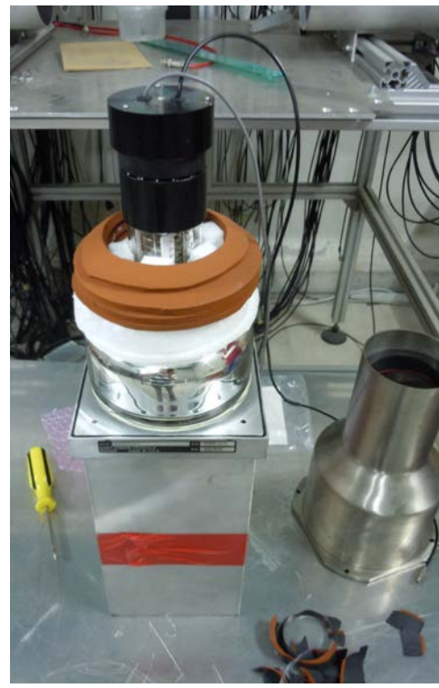
Figura 10. Rivelatore NaI(Tl) 5"x10" prototipo C-BORD
