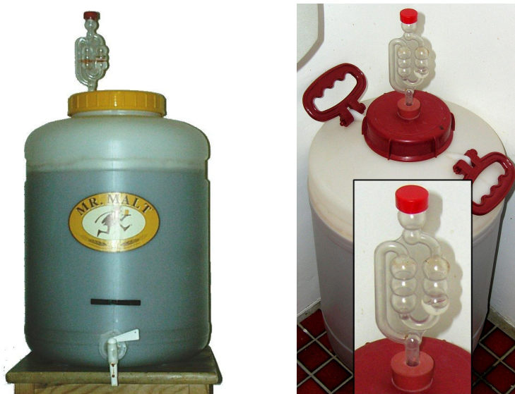
Foto 3.4.4.1: fermentatore a botte in plastica, con particolare del gorgogliatore (Wikipedia)
