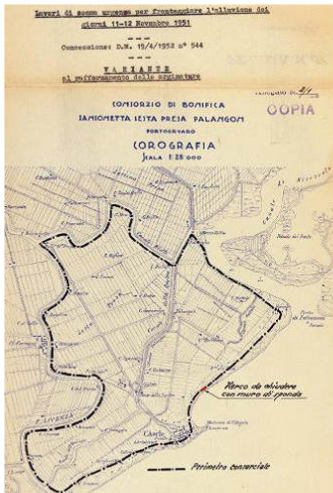
Consorzi di Bonifica Sansonetta-Sesta Presa- Palangon. Lavori di somma urgenza per fronteggiare l'alluvione dei giorni 11-12 Novembre 1951. Corografia della variante al rafforzamento delle arginature, 10 Luglio 1952, fonte Scarpa A. P.
