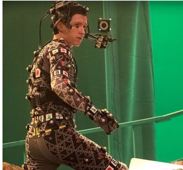
Figura 3.8 Una tuta con sensori passivi di diverse forme utilizzata a scopi cinematografici
