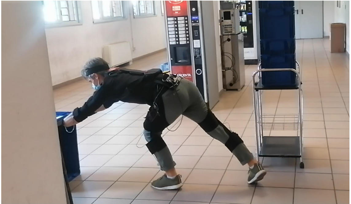
Figura 3.5 Utilizzo di un sistema di motion capture per la calibrazione di uno strumento di valutazione ergonomica
