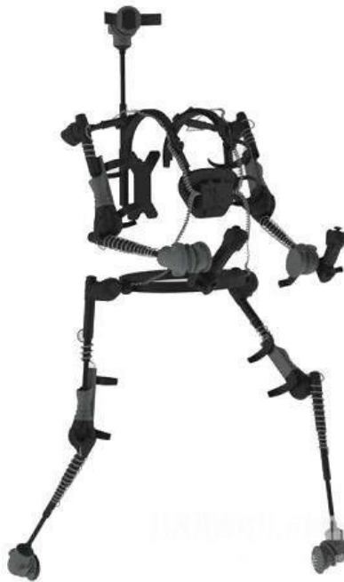
Figura 3.16 Un sistema MoCap elettromeccanico
