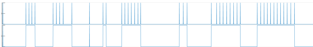
Figura 4.28 In alto: grafico della camminata prima dell' algoritmo di servizio; in basso: il grafico della camminata dopo la pulizia
