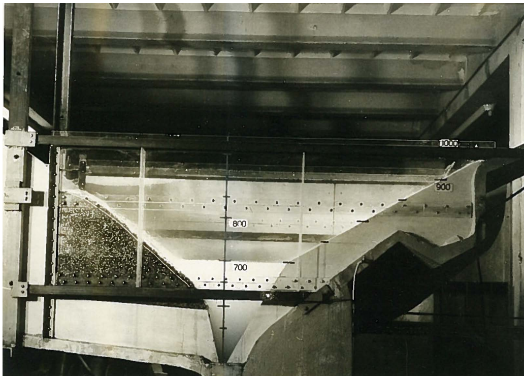
Figura 1.38: Fotografia del modello adottato nelle esperienze svolte all'Istituto di Idraulica dell'Università di Padova. L'immagine riporta lo stato del bacino all'istante in cui la quota del lago è a 700m s.l.m.m. e la ghiaia è mantenuta in posizione da una rete in nylon.
