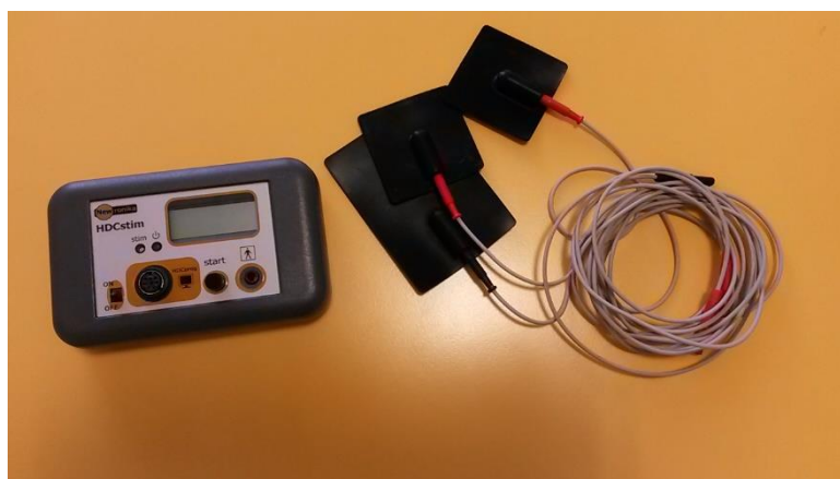
Figura 2. Dispositivo HDC con stimolatore e tre elettrodi
